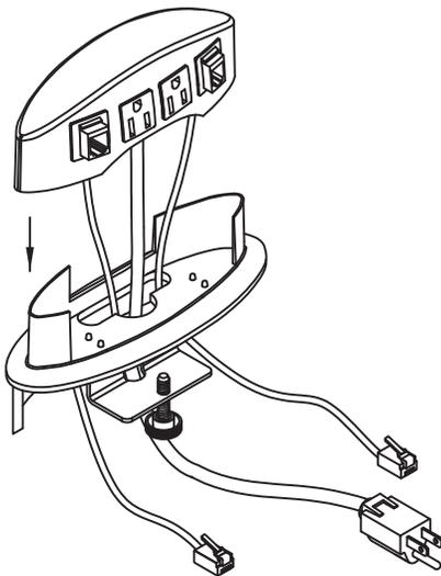
Insertar los cables de datos y energía a través de la base del Lua.
