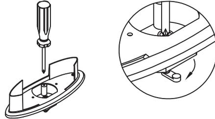
Use un destornillador para apretar las levas de bloqueo y asegurar la base del Lua en la superficie
