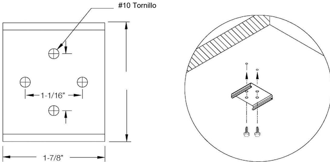
**Nota:** Compruebe que las mediciones coinciden con el soporte anterior antes montar el bracket.
